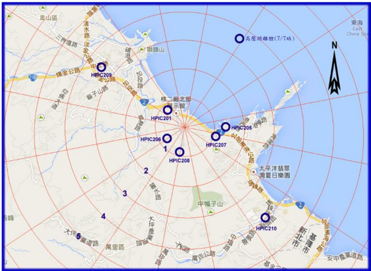
圖 3 核能二廠高壓游離腔監測站分佈圖
